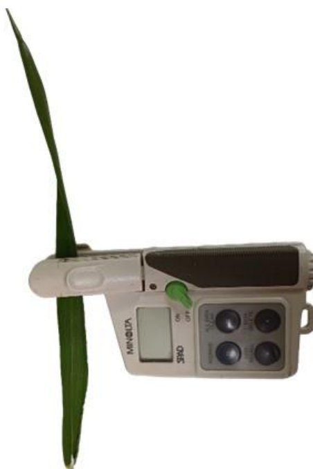
Εικόνα 2.4.1. Το φορητού όργανο μέτρησης SPAD-502 chlorophyll meter (Konica Minolta Optics Inc.).
