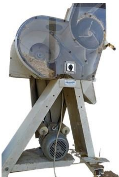
Εικόνα 2.2.3. Ηλεκτρική αλωνιστική μηχανή Wintersteiger LD-180.
