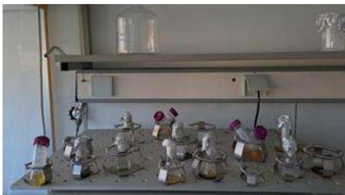
Εικόνα 2.4: Ανάπτυξη των βακτηριακών καλλιεργειών σε μηχανικό αναδευτήρα, 160rpm
