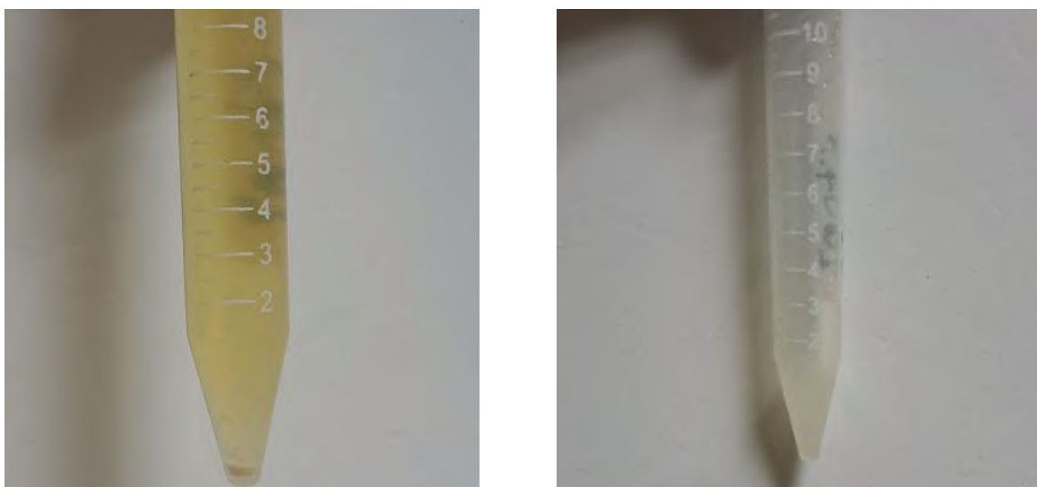
Εικόνα 2.5: Δημιουργία ιζήματος κατά τη φυγοκέντρωση της βακτηριακής καλλιέργειας στις 350 rpm (αριστερά). Παραλαβή καθαρού εμβολίου ύστερα από τη 2 η φυγοκέντρωση (δεξιά).
