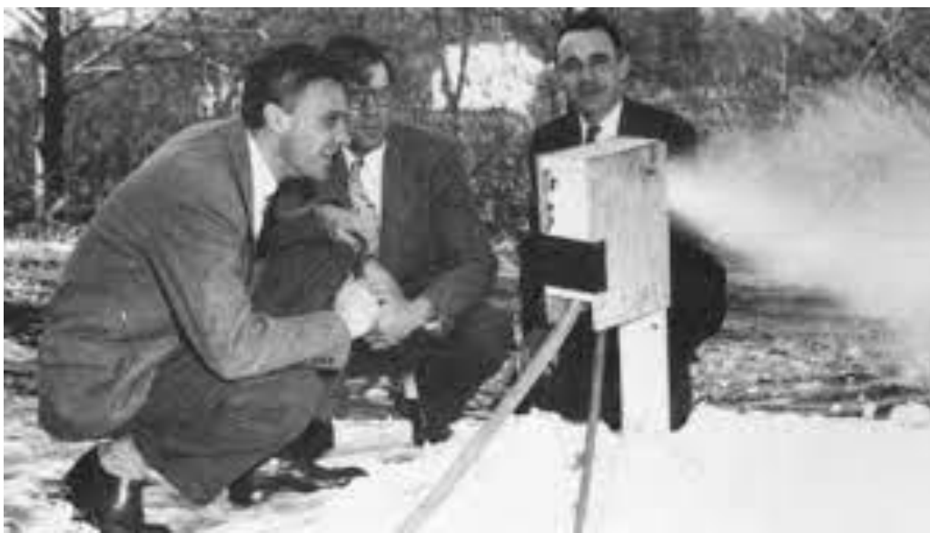
Εικόνα 22. Το πρώτο δίπλωμα ευρεσιτεχνίας για την παραγωγή χιονιού πήγε σε αυτή την ομάδα μηχανικών. Αυτή η εικόνα ήταν η πρώτη δοκιμή του πρωτοτύπου στις 14 Μαρτίου 1950
