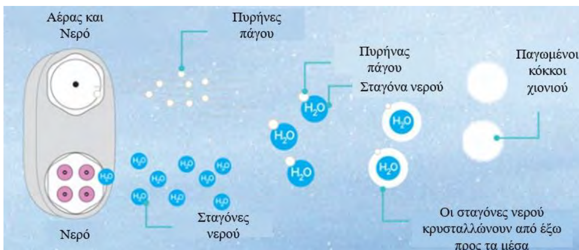
Εικόνα 26. Ακροφύσια κανονιού χιονιού και η διαδικασία με την οποία οι σταγόνες κρυσταλλώνουν καθώς ψεκάζονται
