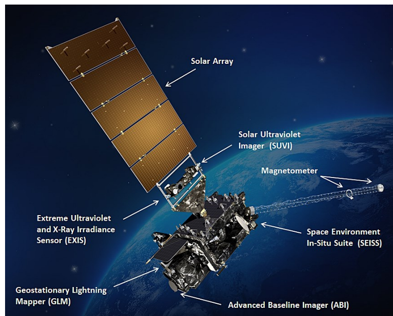
Εικόνα 9: Η εικόνα απεικονίζει έναν γεωστατικό δορυφόρο με τις διάφορες συσκευές και αισθητήρες του. (Πηγή: Wikipedia, 2020)
