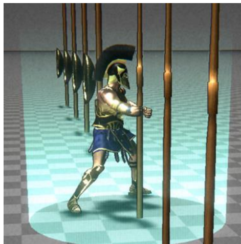
Εικόνα 109 Αρπαγή του ακοντίου με τη χρήση του αλγορίθμου FABRIK Inverse Kinematics στην πλατφόρμα Unity.
