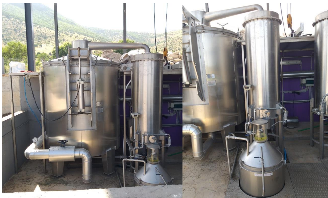
Εικόνα 6: Διαδικασία παραλαβής αιθέριου ελαίου λεβάντας με τη μέθοδο της απόσταξης με ξηρό ατμό
