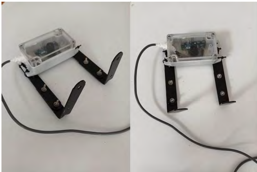
(Εικόνα 5 η : Φυσική απεικόνιση της κάμερας SONY-PS3 και του αδιάβροχου καλύμματός της)
