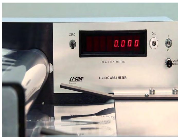
Εικόνα 7. Σαρωτής μέτρησης της φυλλικής επιφάνειας (L-31000C Model) (Li-COR INC, Lincoln, NE, USA).
