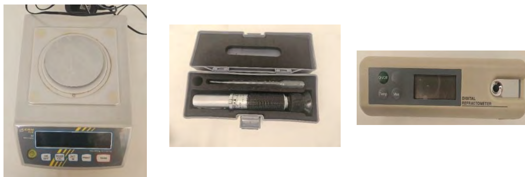
Εικόνα 8. Ζυγαριά ακριβείας KERN PCB250 (αριστερά), οπτικό (κέντρο) και ψηφιακό (δεξιά) διαθλασίμετρο για την μέτρηση του γλεύκους σε ολικά διαλυτά στερεά.
