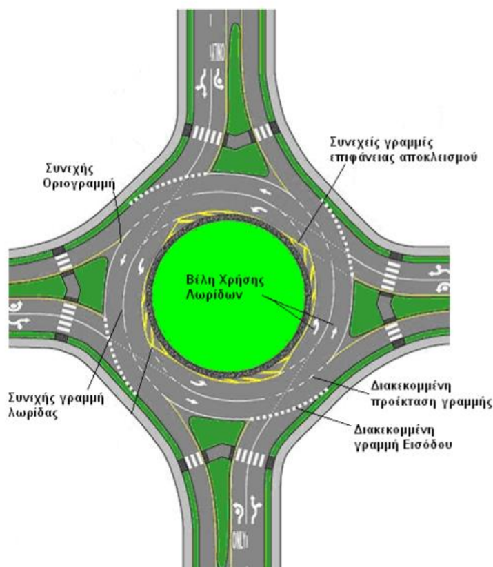
Εικόνα 8-1: Διάταξη Σπειροειδή Δακτυλίου Κυκλοφορίας (turbo-K3)
