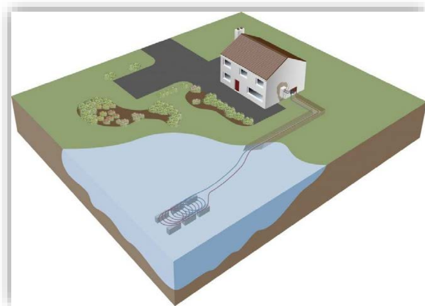
Εικόνα 6-3 Μορφή αντλίας θερμότητας με μια κοντινή πηγή νερού [10]
