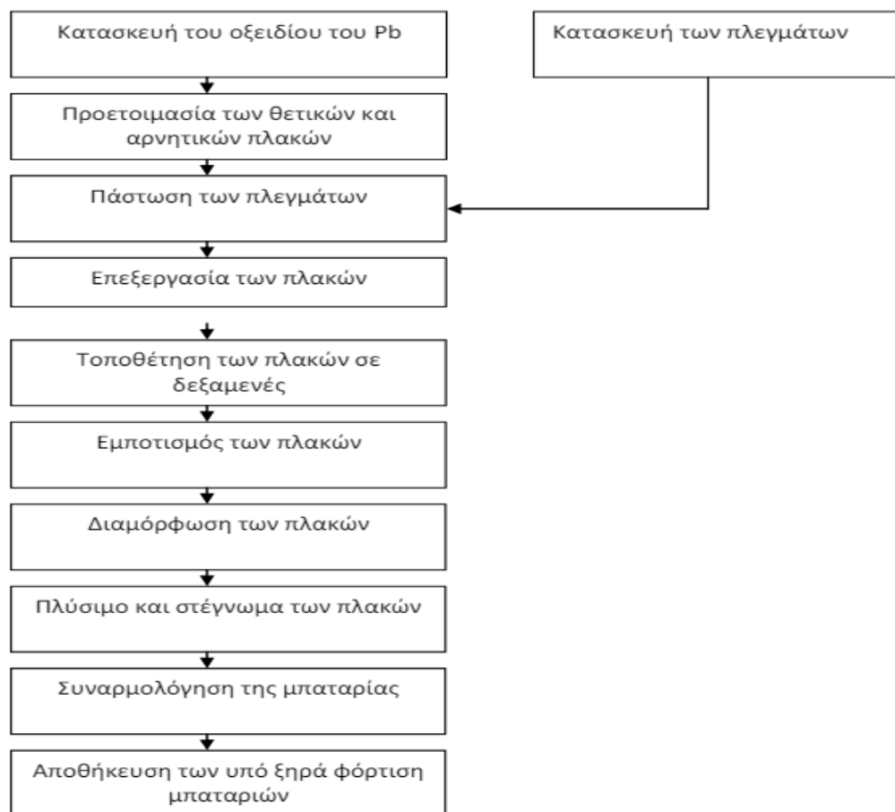
Εικόνα 20: Διάγραμμα διαδικασίας της κατασκευής ενός συσσωρευτή AGM
