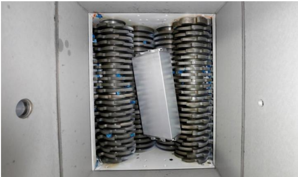
Εικόνα 13: Σύνθλιψη των κελιών μίας μπαταρίας με τη βοήθεια του κονιορτοποιητή [12],[17].
