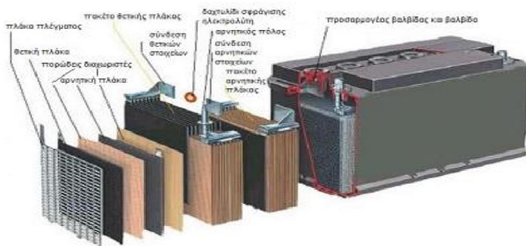
Εικόνα 14: Δομή ενός συσσωρευτή τύπου VRLA
