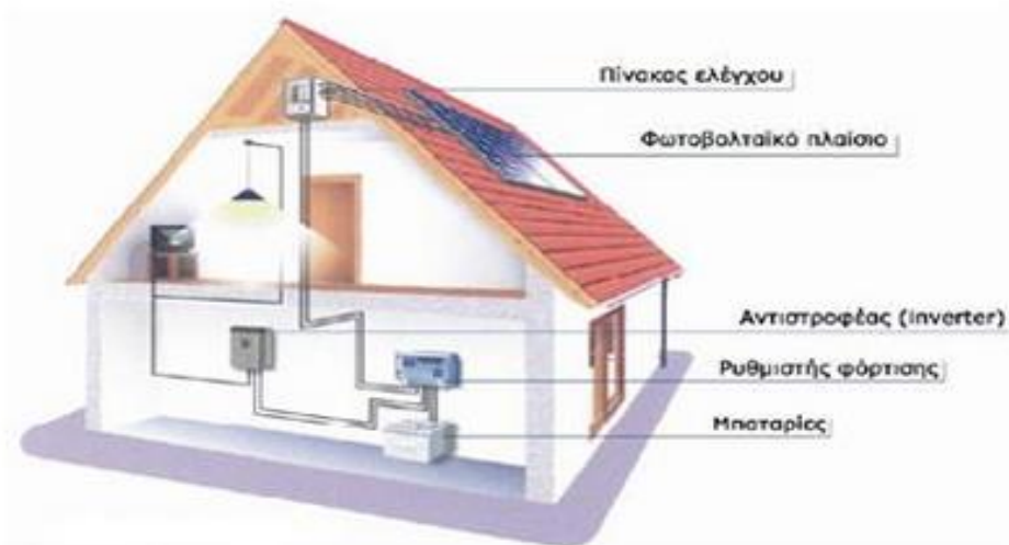
Εικόνα 24: Υποσυστήματα ενός αυτόνομου φωτοβολταϊκού συστήματος [29].
