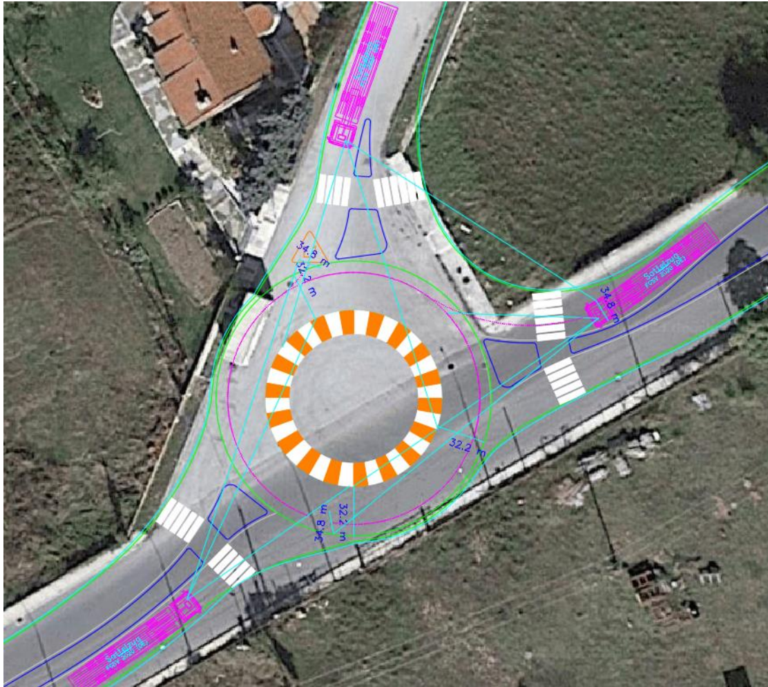
Εικόνα 24: Τρίγωνα ορατότητας κατά την είσοδο στο δακτύλιο κυκλοφορίας του κόμβου 1
