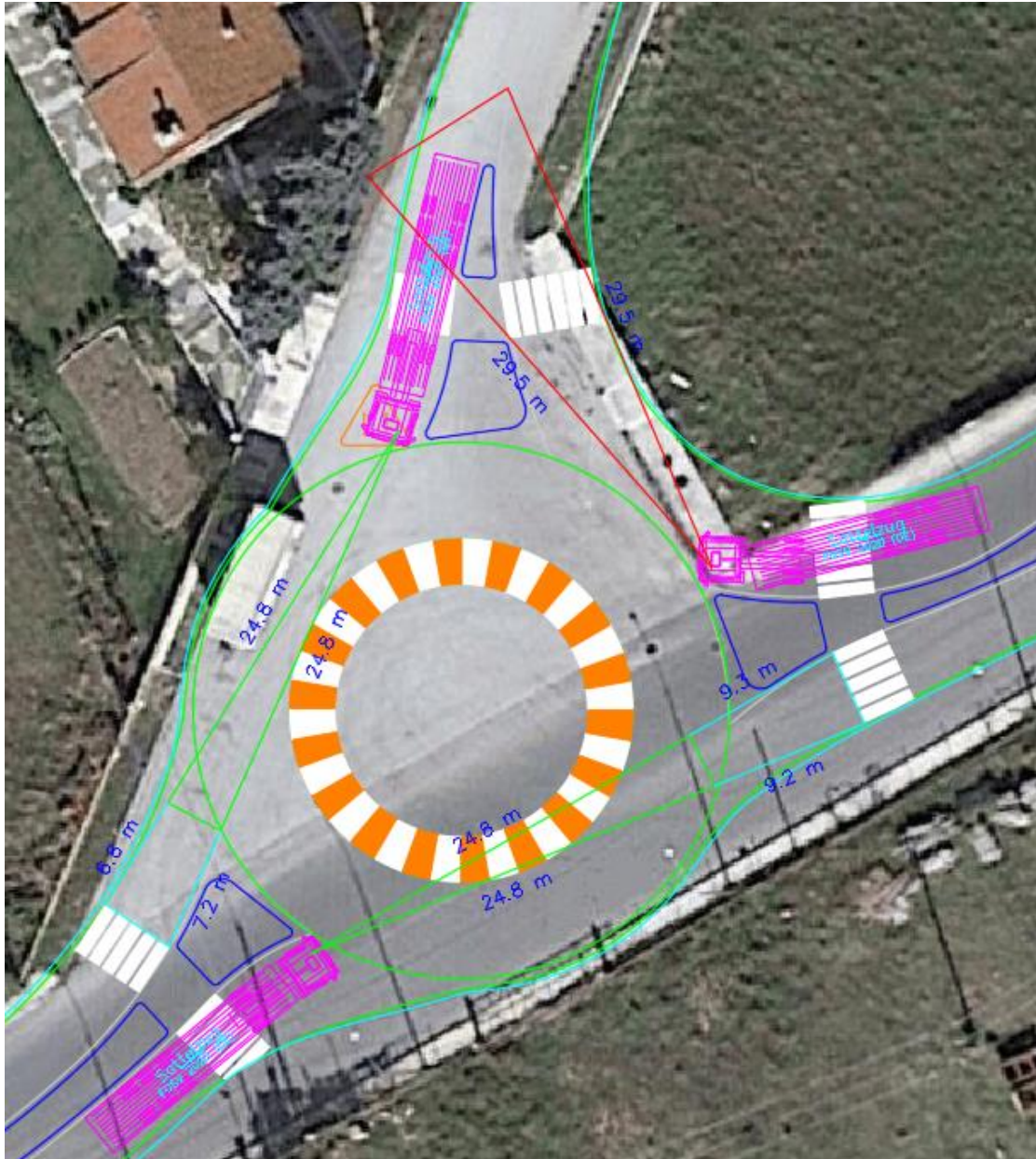
Εικόνα 23: Μήκος ορατότητας για στάση μέχρι τη διάβαση πεζών της εξόδου του κόμβου 1
