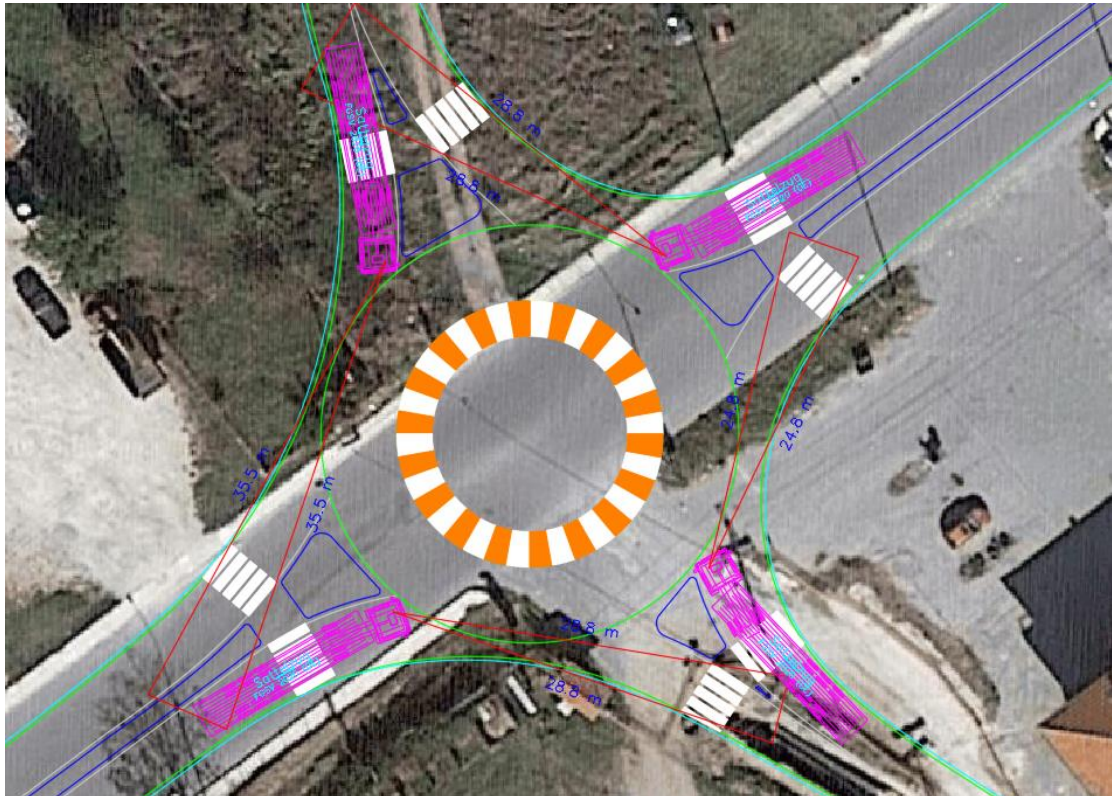
Εικόνα 28: Μήκος ορατότητας για στάση μέχρι τη διάβαση πεζών της εξόδου του κόμβου 2
