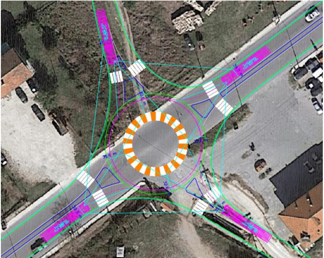
Εικόνα 29: Τρίγωνα ορατότητας κατά την είσοδο στο δακτύλιο κυκλοφορίας του κόμβου 2
