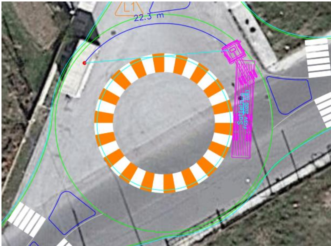
Εικόνα 26: Μήκος ορατότητας για στάση επί του δακτυλίου κυκλοφορίας του κόμβου 1
