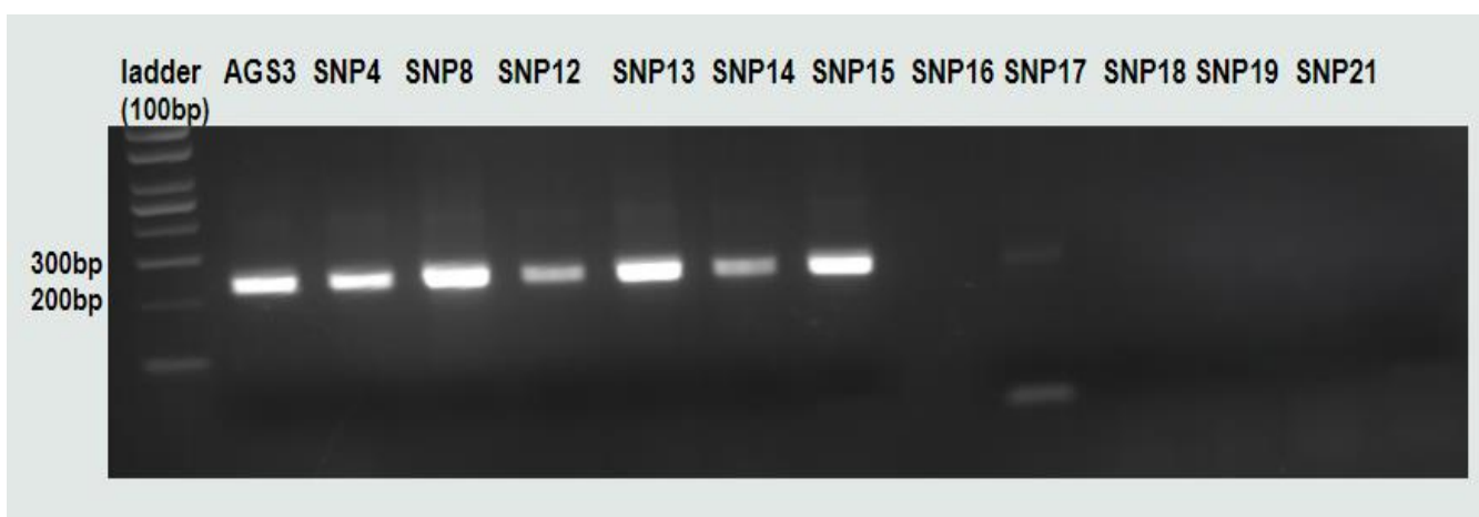
Εικόνα 17: Απεικόνιση των προϊόντων της διαγνωστικής PCR για τους εκκινητές ακτίνης για τους κλώνους 4,8,12,13,14,15,16,17,18,19,21 και το control AGS3 που ηλεκτροφορήθηκαν σε gel αгарόζης.
