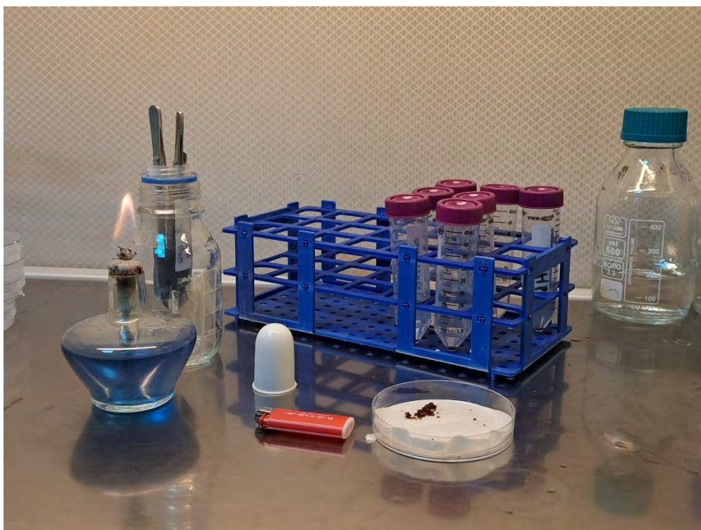
Εικόνα 2.1 Ξήρανση των σπόρων με τοποθέτησή τους σε διηθητικό χαρτί και ολιγόλεπτη επώαση σε θερμοκρασία δωματίου, εντός της τράπεζας νηματικής ροής.
