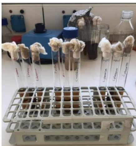
Εικόνα 24: Επώαση προστατευτικών μικροοργανισμών σε δοκιμαστικούς σωλήνες με υγρό θρεπτικό υπόστρωμα
