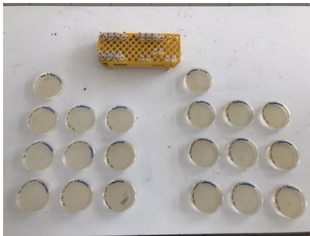
Εικόνες 27 & 28: Προστατευτικά αντιμικροβιακά διαλύματα ζωντανών κυττάρων, νεκρών κυττάρων και υπερκείμενου διαλύματος και εμβολιασμός τους σε τρυβλία με θρεπτικό υπόστρωμα
