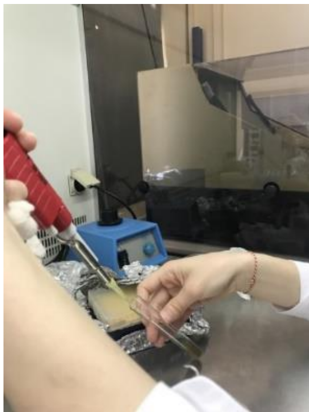
Εικόνες 37 & 38: Εμβολιασμός τρυβλίων με τον μικροοργανισμό στόχο Aspergillus flavus και με τα αντιμικροβιακά διαλύματα, με τη χρήση πιπέτα μέσα σε θάλαμο νηματικής ροής
