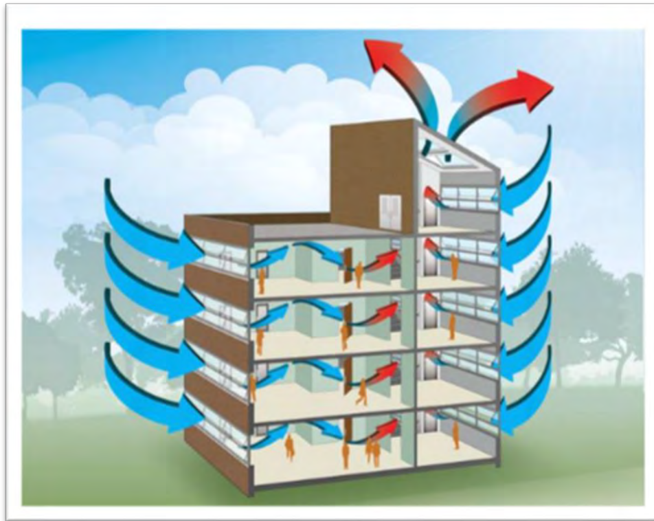
Εικόνα 13: Φυσικός αερισμός του κτιρίου. Πηγή: https://topos-solutions.gr .
