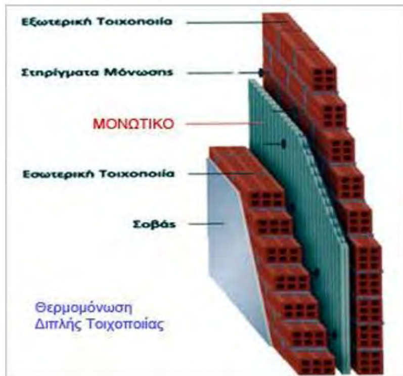
Εικόνα 12: Θερμομόνωση Διπλής Τοιχοποιίας. Πηγή: https://fragoulakis.gr/thermomonomosi .
