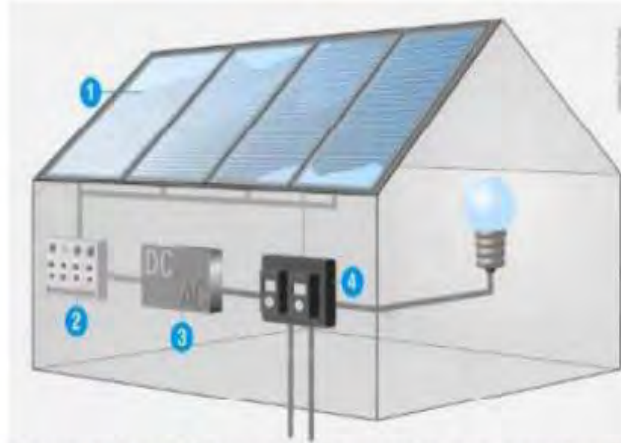
Φ/Β σύστημα: 1.Φ/Β πλαίσια-2.Πίνακας ελέγχου-3.Αντιστροφέας(inverter)-4.Μετρητής
