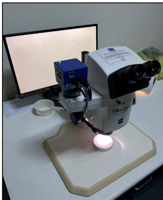
Εικόνα 2.3.4 Στερεοσκόπιο στο χώρο του εργαστηρίου.
