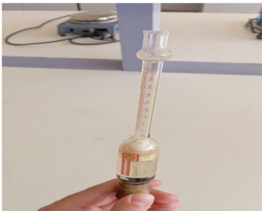
Εικόνα 22: Βουτυρόμετρο αφού έχει προστεθεί το δείγμα, μέθοδος Gerber(Πηγή: Προσωπικό αρχείο Χρυσούλας Νταλαμπίρα)
