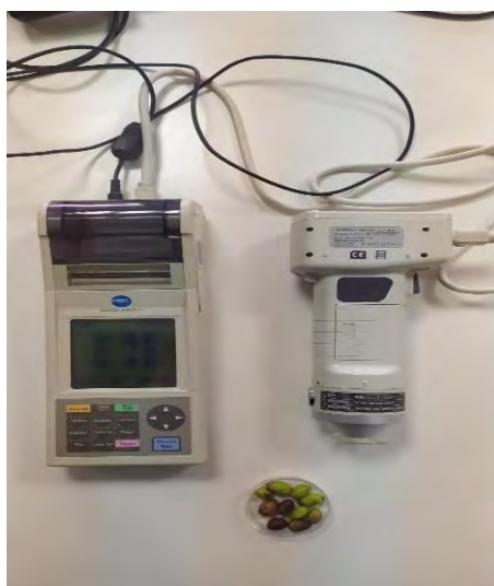
Εικόνα 2.4 Μέτρηση του χρώματος του επικαρπίου καρπών ελιάς ποικιλίας Κορωνέικη με το χρωματόμετρο Minolta.
