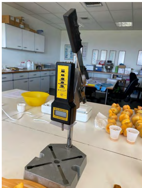
Εικόνα 2.2.3.3. Ηλεκτρονικό πενετρόμετρο Turoi (53205 Digital Fruit Pressure Tester, Forli, Italy)
