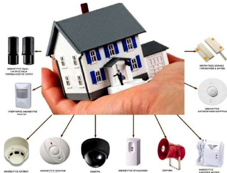
Εικόνα 3: IoT Σύστημα ασφαλείας για Smart Home εφαρμογές
