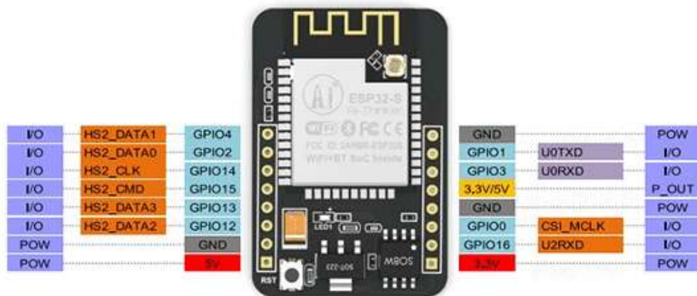
Εικόνα 29: Θέσεις ακροδεκτών του ESP32-CAM
