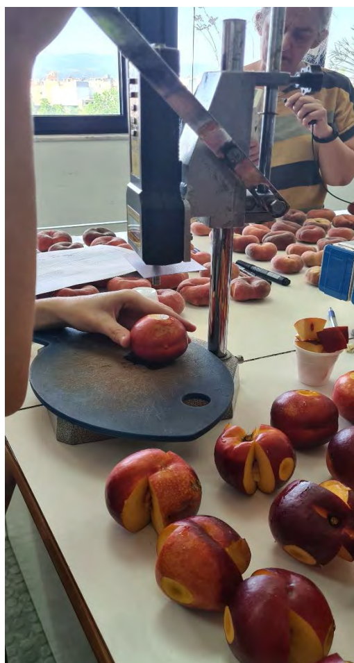
Εικόνα 2.6.3 Μέτρηση σκληρότητας σάρκας με ηλεκτρονικό πενετρόμετρο Turoni (53205 Digital Fruit Pressure Tester, Forlì, Italy)
