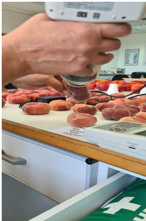
Εικόνα 2.6.2 Μέτρηση χρώματος φλοιού με το χρωματόμετρο Minolta chroma meter (Model CR-400, Minolta Ltd, Osaka, Japan)
