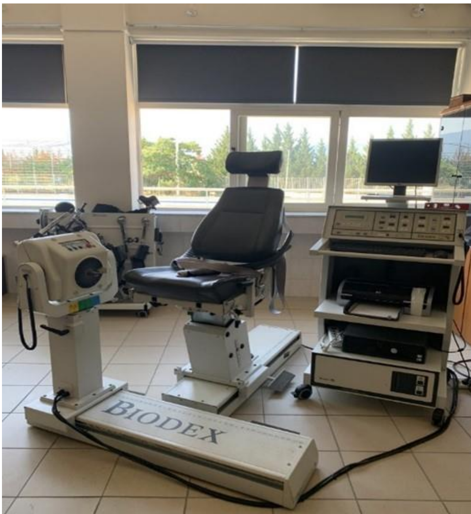
Εικόνα 6.1 Το ισοκινητικό δυναμόμετρο Biodex 3 pro.
