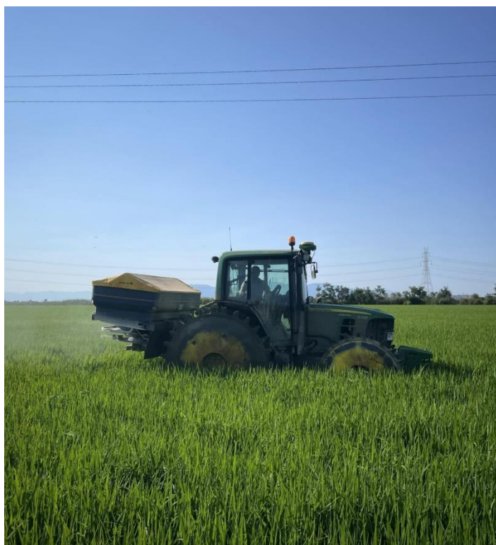
Εικόνα 4: Διαδικασία Λίπανσης ρυζιού με λιπασματοδιανομέα επάνω σε γεωργικό ελκυστήρα με σιδερένιους τροχούς (Προσωπική Λήψη)
