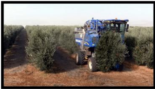
Εικόνα 5: Μηχανή Συγκομιδής ελαιόκαρπων ( www.agro24.gr )
