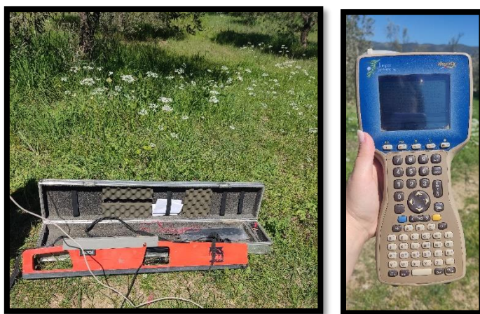
Εικόνα 11: Φωτογραφίες του Επαγωγικού Αισθητήρα EM38 και του Σύστηματος GNSS
