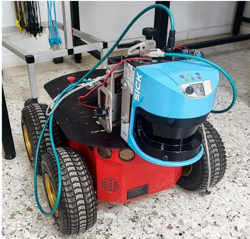
Εικόνα 12, Το ρομπότ Pioneer 3-AT με τον αισθητήρα SICK LMS500 που χρησιμοποιήσα για την υλοποίηση της εργασίας
