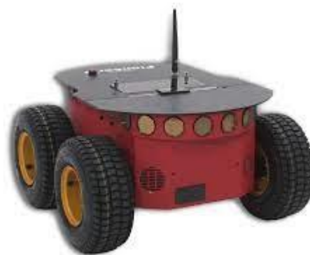
Εικόνα 2, Pioneer 3-AT model
