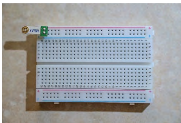
Εικόνα 2929. Τοποθέτηση του πιεζοηλεκτρικού στοιχείου στην breadboard.
