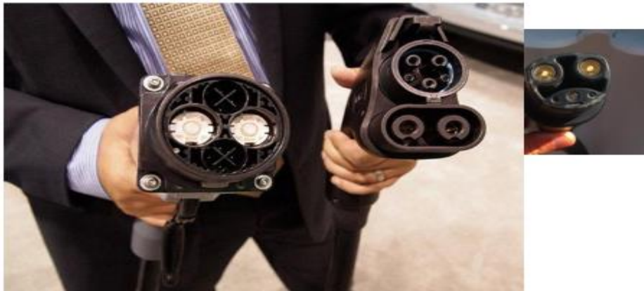
Εικόνα 4: Το ChaDemo (αριστερά) και ο συνδυασμένος φορτιστής Sae (δεξιά)
