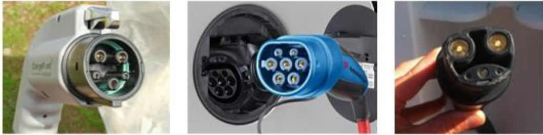
Εικόνα 3: Τα βύσματα φόρτισης AC από αριστερά προς τα δεξιά: US Type 1 SAE, European Type 2
