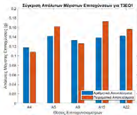
Εικόνα Α. 53: Σύγκριση απόλυτων μέγιστων επιταχύνσεων για την περίπτωση T3EQ1, με κατανομημένο αρχικό μέτρο διάτμησης, υιοθέτηση G-y-D καμπυλών βαθμονομημένες για μέση τάση που αντιστοιχεί στο μέσο βάθος εγκιβωτισμού της σήραγγας και απόσβεση Rayleigh 3%
