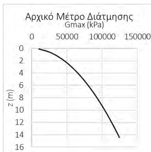
Εικόνα 3.12: Κατανομή του Αρχικού Μέτρου Διάτμησης G_{max} (kPa) με το βάθος z (m)
