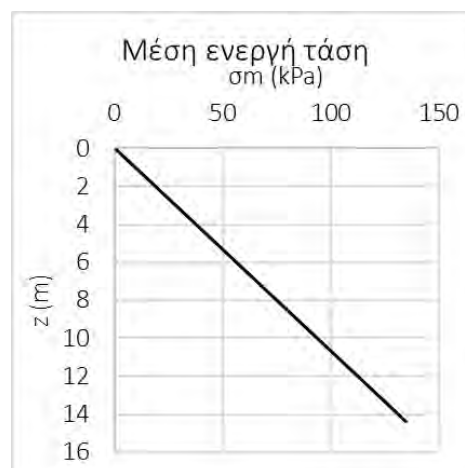
Εικόνα 3.11: Κατανομή της μέση ενεργής τάσης \sigma_m (kPa) με το βάθος z (m) για την άμμο Fontainebleau NE34
