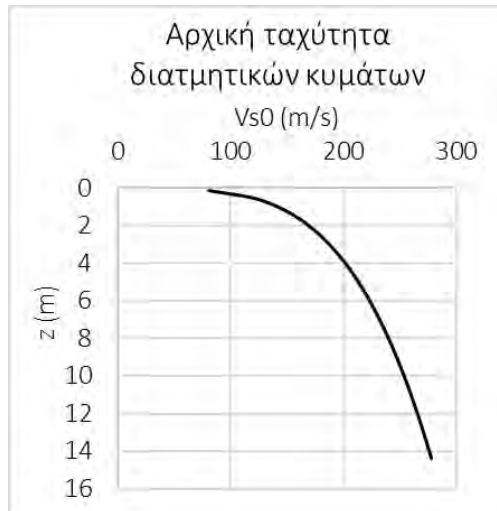
Εικόνα 3.13: Κατανομή της αρχικής ταχύτητας διατμητικών κυμάτων V_{s0} (kPa) με το βάθος z (m)
