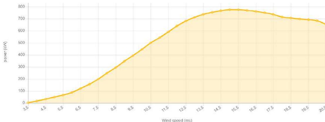
Διάγραμμα 36: Καμπύλη ισχύος για το Αιολικό πάρκο 11 (πριν την εφαρμογή του Repowering)
