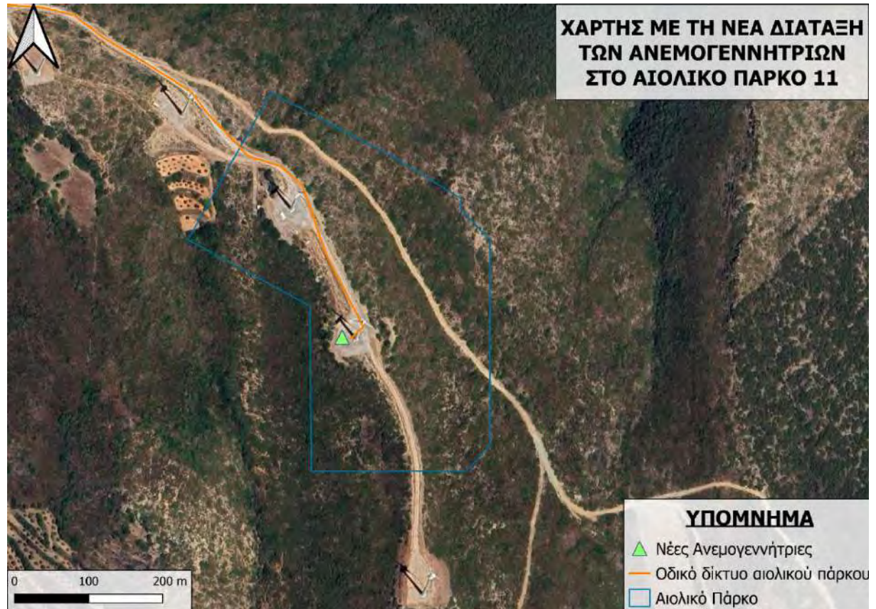
Χάρτης 34: Νέα διάταξη των Α/Γ για το Αιολικό πάρκο 11 (μετά την εφαρμογή του Repowering)
