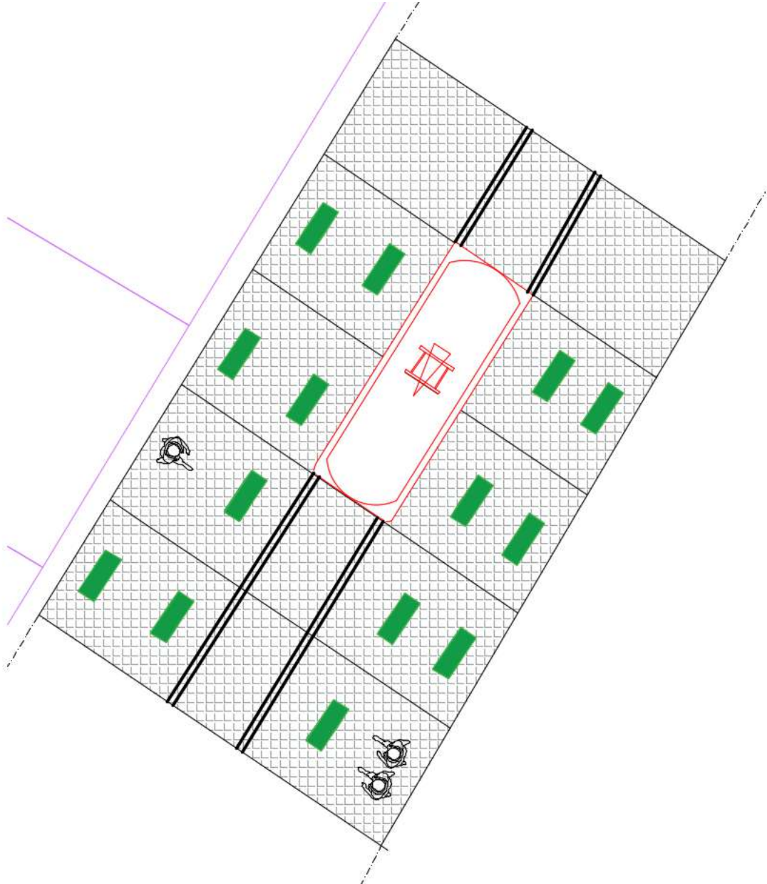
Εικόνα 71. Μετατροπή της οδού Αιολίδος σε ήπιας κυκλοφορίας και τοποθέτηση προειδοποιητικών LED Πηγή: Ιδία επεξεργασία
