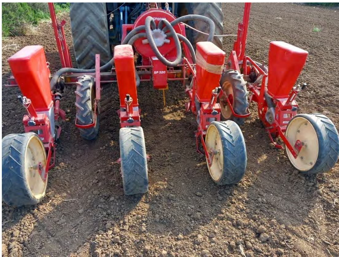
Εικόνα 2.3. Πνευματική σπαρτική μηχανή που χρησιμοποιήθηκε για τη σπορά της καλλιέργειας στις 2 Μαΐου.
