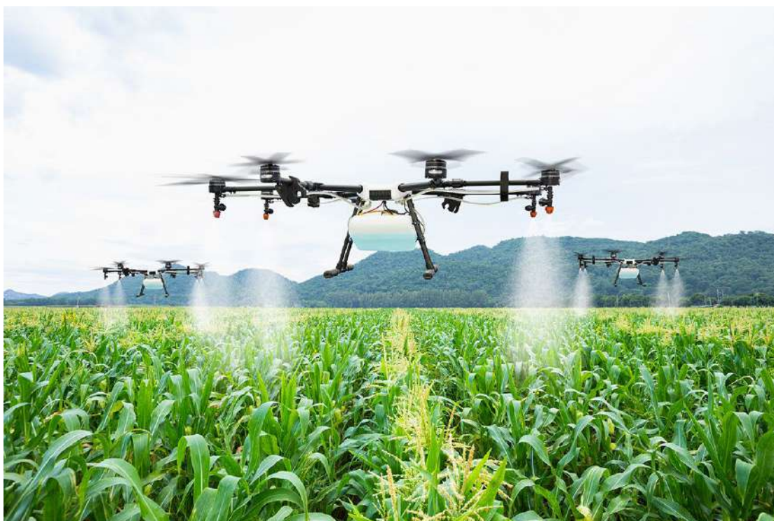
Εικόνα 6: UAV στον αγροτικό τομέα που χρησιμοποιείται για ψεκασμό αγροκτήματος
