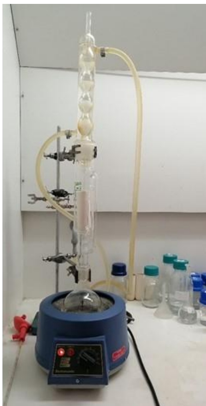
Εικόνα 2.7 Εκχύλιση κατά Soxhlet για εκτίμηση της ελαιοπεριεκτικότητας.
