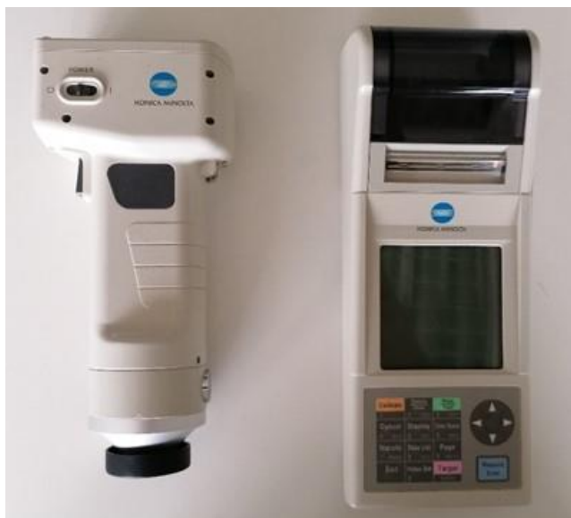
Εικόνα 2.4 Χρωματόμετρο Minolta (Model CR-400, Minolta Ltd, Osaka, Ιαπωνία) για την μέτρηση του χρώματος επικαρπίου ελιάς.
