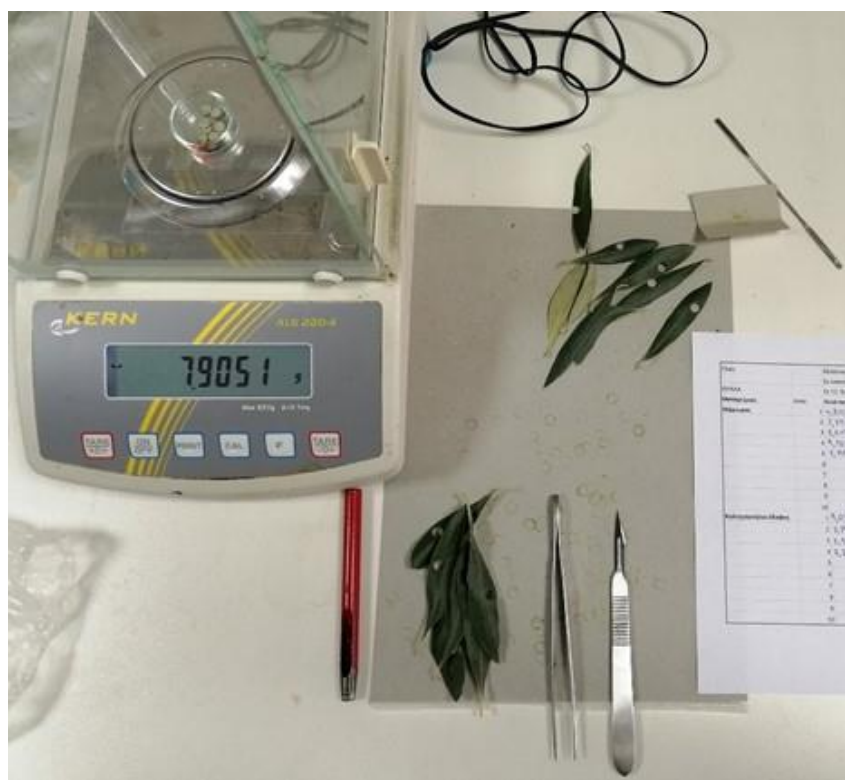
Εικόνα 2.2 Λήψη 12 δίσκων ελάσματος φύλλων ελιάς κάθε επανάληψης για την μέτρηση ξηράς ουσίας και του ειδικού βάρους φύλλων.
