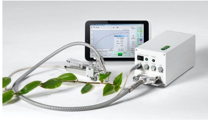
Εικόνα 7: Όργανο Chlorophyll Fluorimeter PAM-1200 για μέτρηση του φθορισμού της χλωροφύλλης a.
