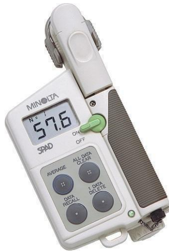
Εικόνα 6: Όργανο μέτρησης SPAD-502 για μέτρηση της χλωροφύλλης στα φύλλα.
