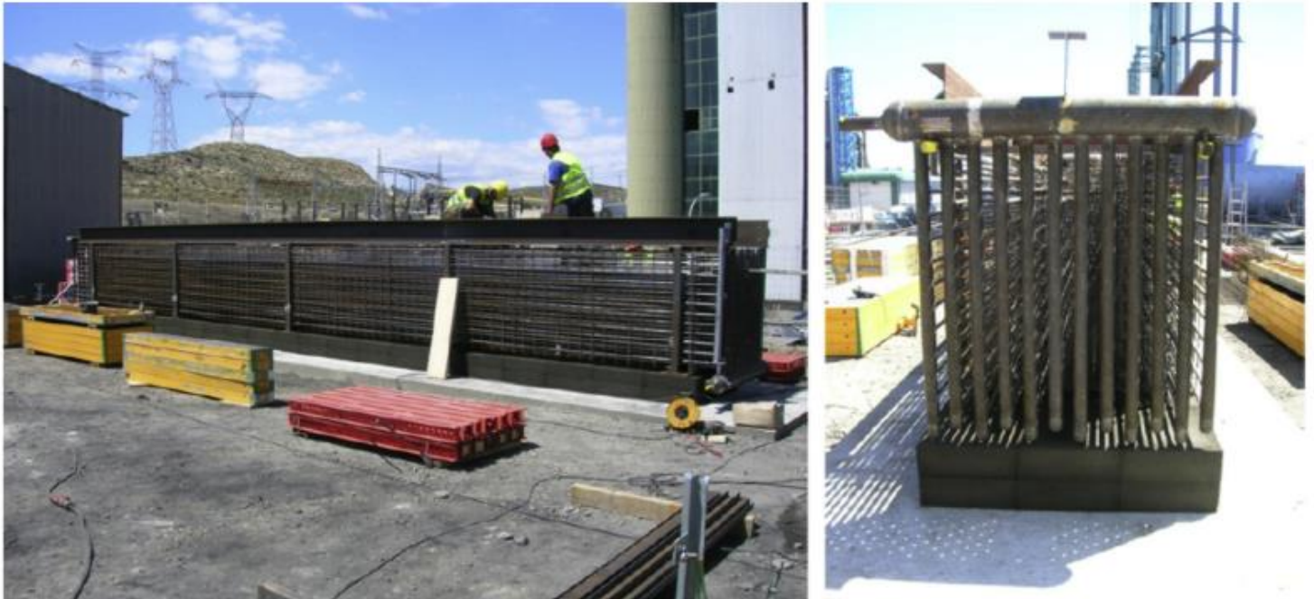
Σχήμα 12: Δοκιμαστική διάταξη (χωρίς θερμομόνωση) θερμικής αποθήκευσης με σκυρόδεμα με εντοιχισμένες κατασκευές
