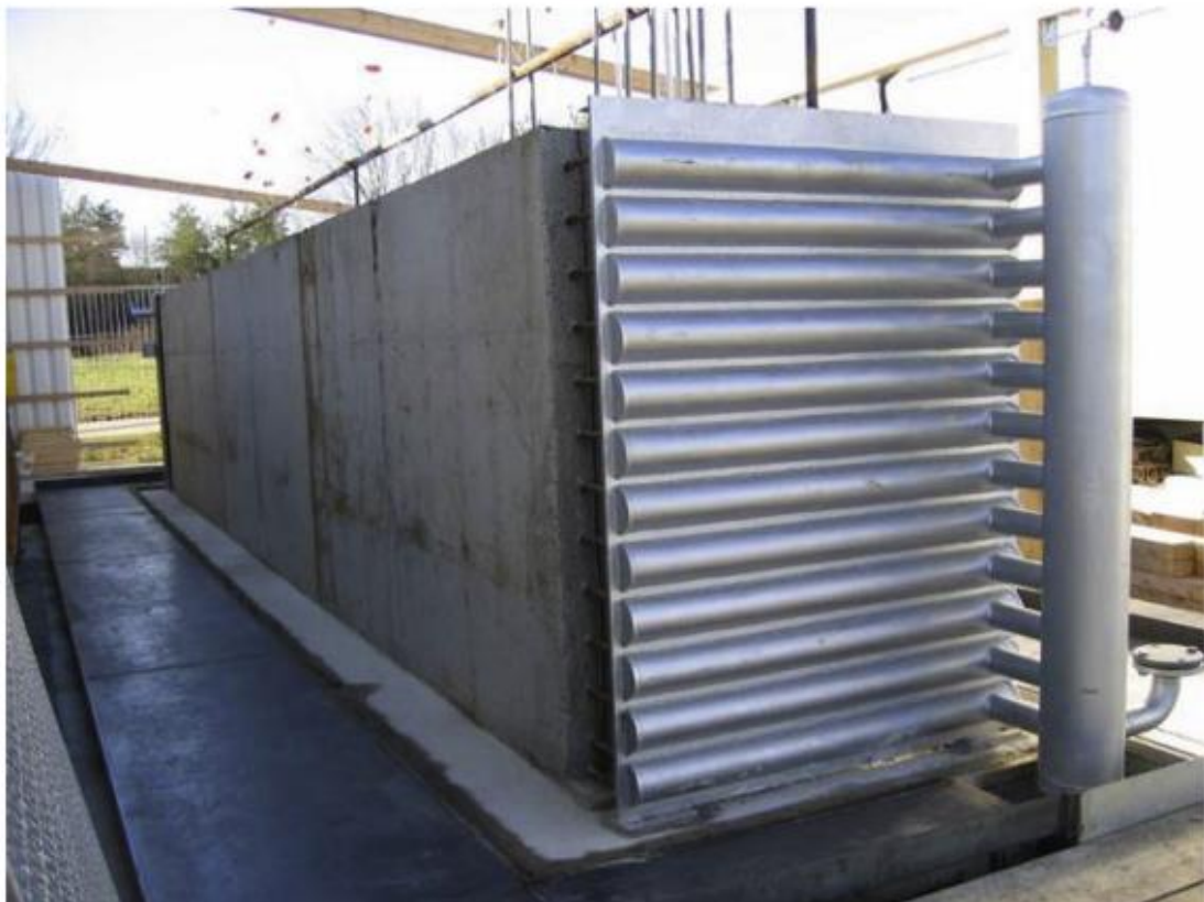
Σχήμα 12: Δοκιμαστική διάταξη (χωρίς θερμομόνωση) θερμικής αποθήκευσης με σκυρόδεμα με εντοιχισμένες κατασκευές
