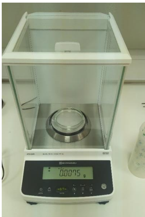
Εικόνα 6. Ζύγισμα ωτολίων σε ζυγό ακριβείας. Πηγή: προσωπικό αρχείο συγγραφέα.
