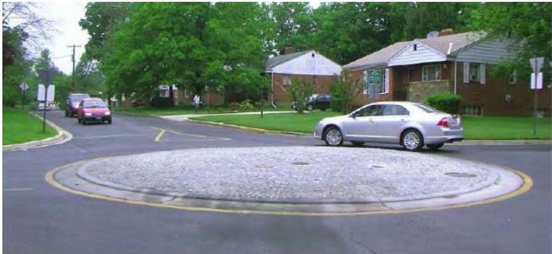
Εικόνα 2.10 : Κομβίδιο κυκλικής κίνησης σε υφιστάμενη διασταύρωση με υπερυψωμένη κεντρική νησίδα (συνιστάται υπερύψωση max 12,5 cm στο κέντρο)
