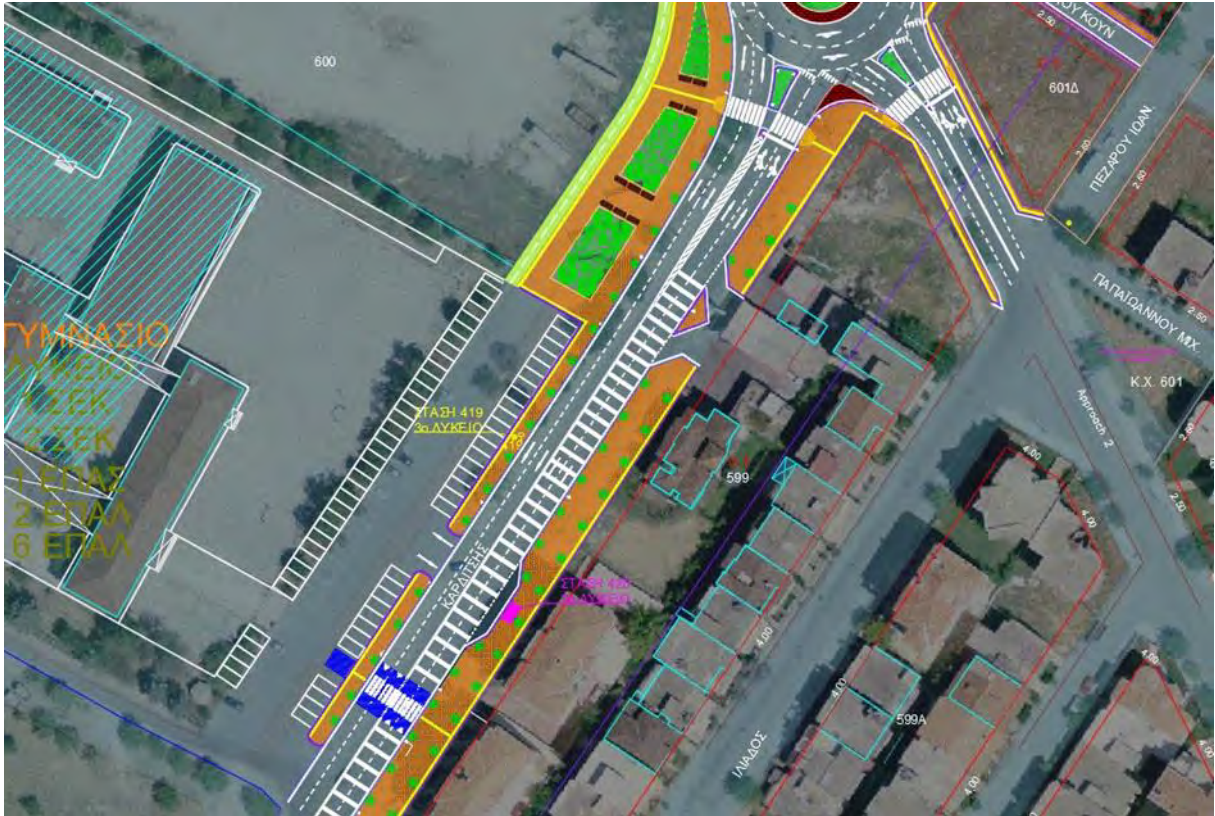
Εικόνα 5.3 : Προειδοποιητική διαγράμμιση μείωσης ταχύτητας οχημάτων
