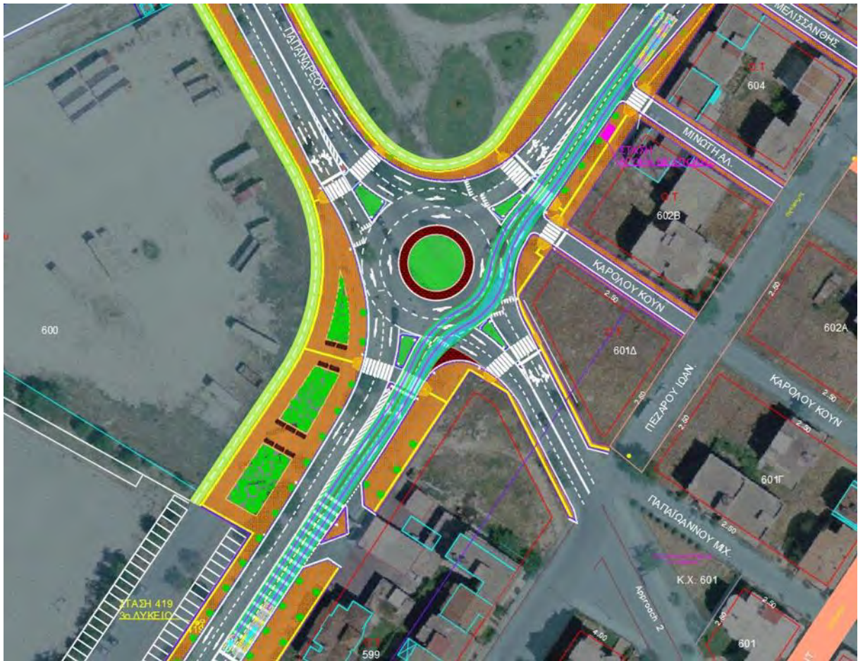
Εικόνα 5.2 : Γρηγορότερη διαδρομή του κυκλικού κόμβου
