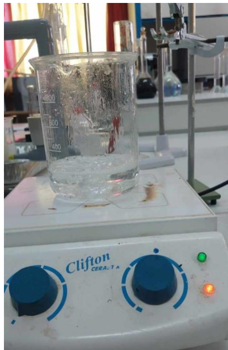
Εικόνα 4.5: Συσκευή ανάμιξης με την χρήση μαγνήτη
