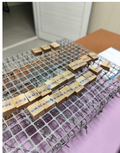
Εικόνα 4.9: Τοποθέτηση δοκιμίων Δρυός σε ειδικές σήτες
