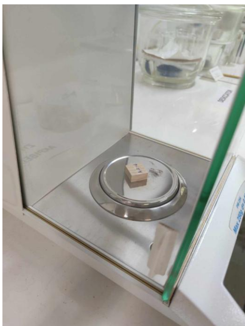
Εικόνα 5: Ζύγιση δοκιμίου Αΐλανθου σε ζυγό ακριβείας μετά την εμφάνιση, Εικόνα 6: Ομάδες δοκιμίων Αΐλανθου
