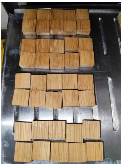
Εικόνα 7: Δοκίμια Αΐλανθου μέσα στο θάλαμο Suntest XLS+, Εικόνα 8: Δοκίμια Δρυός μέσα στο θάλαμο Suntest XLS+
