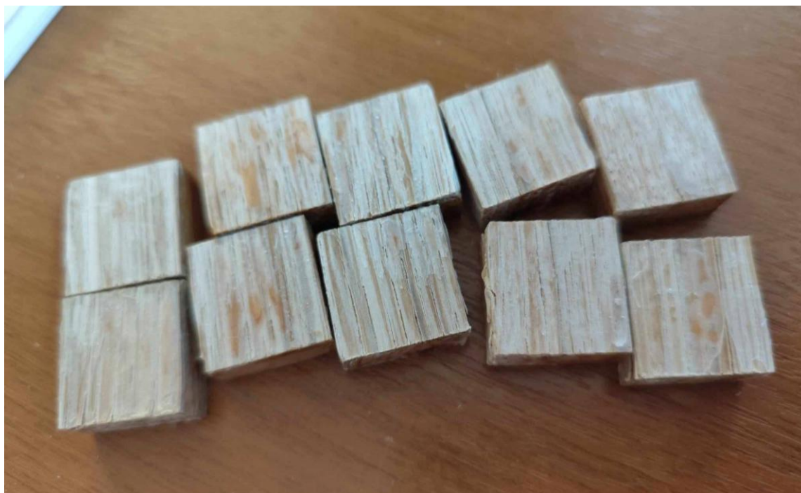
Εικόνα 5.1: Δοκίμια Δρυός περιεκτικότητας 4% νανοσωματιδίων μετά από 28 μέρες
