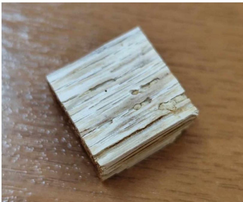
Εικόνα 5.8: Εκτεθειμένη επιφάνεια δοκιμίου μάρτυρα Δρυός μετά από 28 μέρες
