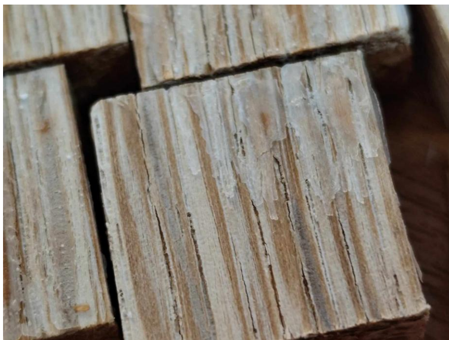
Εικόνα 5.2: Δοκίμιο Δρυός περιεκτικότητας 4% νανοσωματίδια μετά από 28 μέρες
