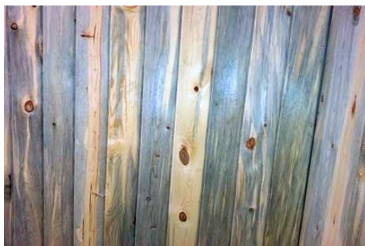
Εικόνα 2.1: Προσβολή κυάνωσης σε ξυλεία
