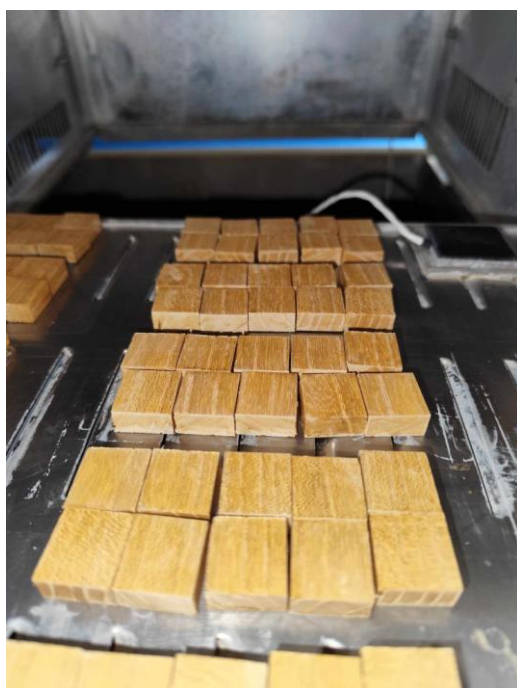
Εικόνα 7: Δοκίμια Αΐλανθου μέσα στο θάλαμο Suntest XLS+, Εικόνα 8: Δοκίμια Δρυός μέσα στο θάλαμο Suntest XLS+
