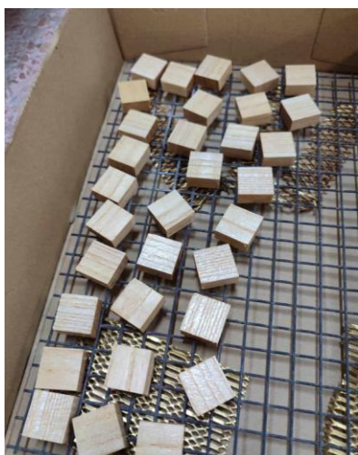
Εικόνα 4.8: Τοποθέτηση δοκιμίων Αΐλανθου σε ειδικές σήτες
