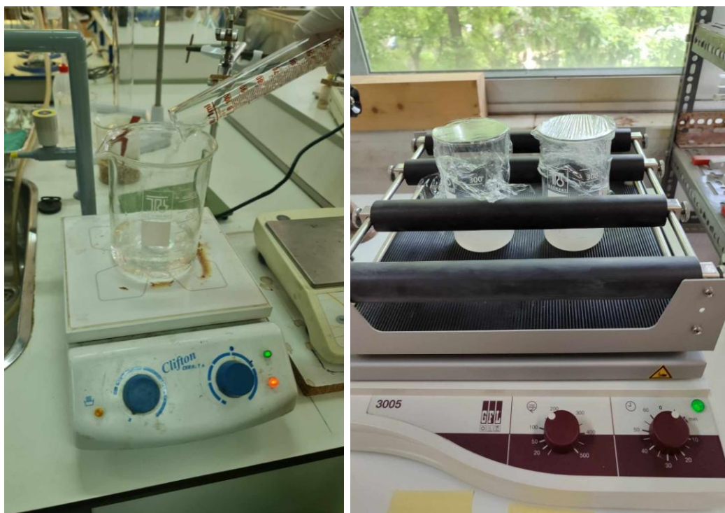
Εικόνα 1: Προετοιμασία νανοςύνθετου μίγματος, Εικόνα 2: Έτοιμα νανοςύνθετα μίγματα διαφορετικών ποσοστών
