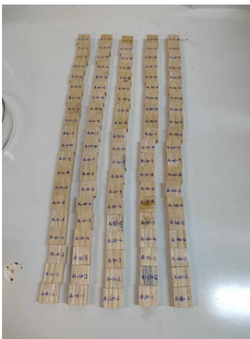
Εικόνα 5: Ζύγιση δοκιμίου Αΐλανθου σε ζυγό ακριβείας μετά την εμφάνιση, Εικόνα 6: Ομάδες δοκιμίων Αΐλανθου
