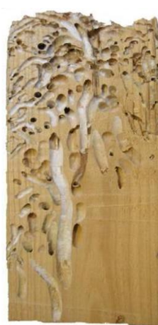
Εικόνα 2.7: Προσβολή ξύλου από θαλάσσιο μικροοργανισμό
