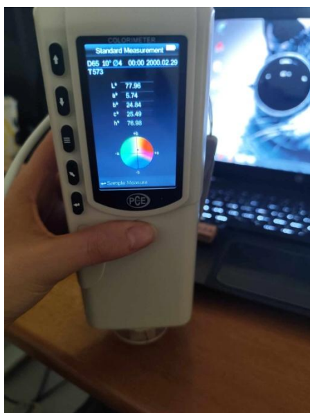
Εικόνα 4.2: Μέτρηση χρώματος επιφάνειας δοκιμίου
