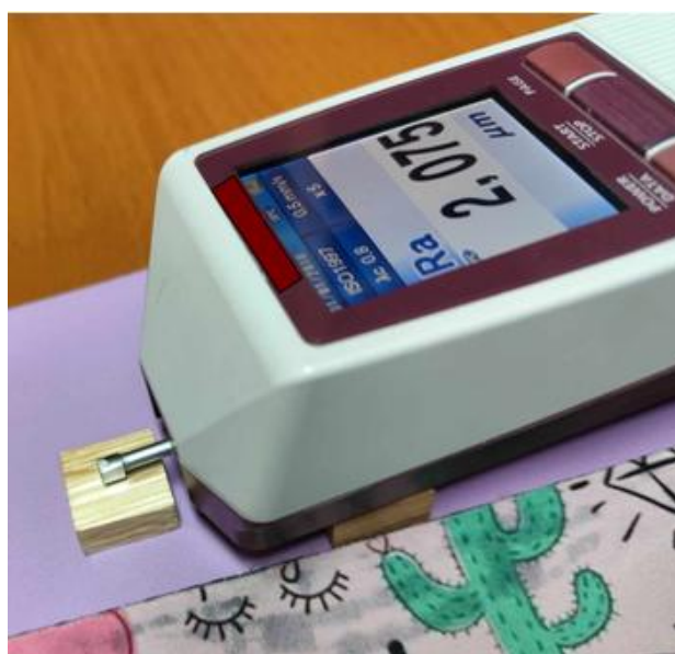
Εικόνα 4.3: Μέτρηση τραχύτητας σε δοκίμιο Δρυός
