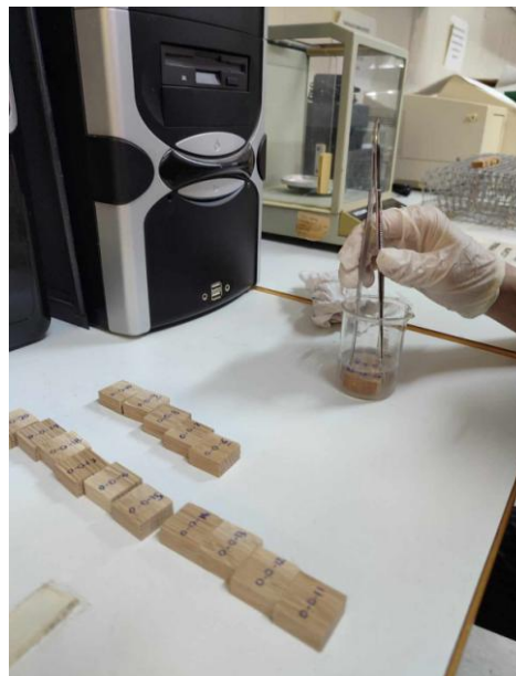
Εικόνα 4.7: Εμβάπτιση και ζύγιση δοκιμίων Δρυός
