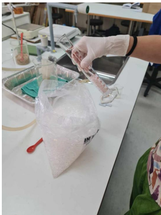
Εικόνα 4.4: Μέτρηση όγκου Paraloid B72
