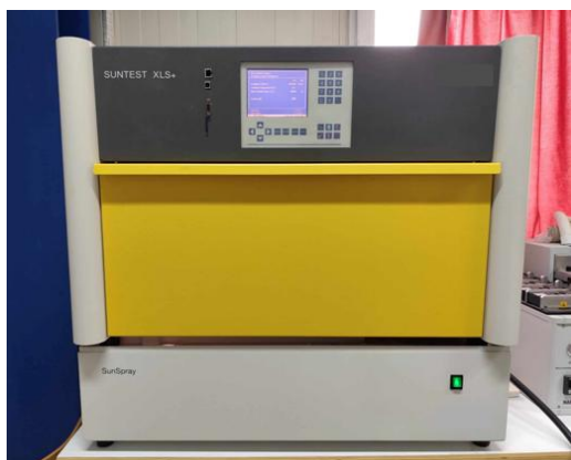
Εικόνα 4.11: Θάλαμος – συσκευή τεχνητής γήρανσης Suntest XLS+
