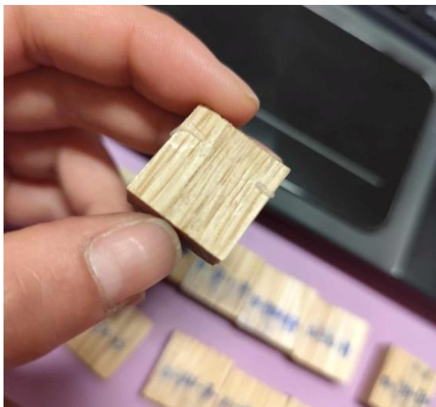
Εικόνα 4.10: Δοκίμιο Δρυός μετά τον κλιματισμό, περίσσιο υλικό από την εμφάνιση
