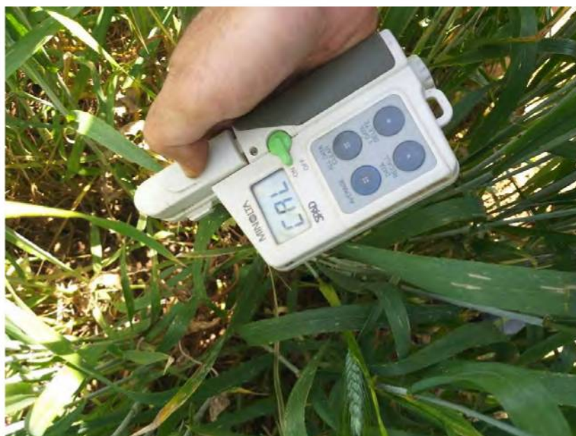
Εικόνα 3.5. Το όργανο “SPAD-502 chlorophyll meter” που χρησιμοποιήθηκε για τη μέτρηση της συγκέντρωσης της χλωροφύλλης στα φυτά σκληρού σιταριού.
