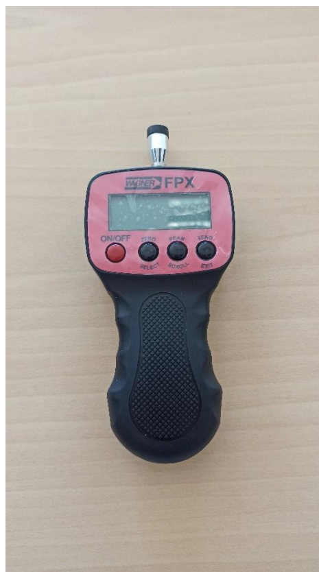
Εικόνα 3.7 Wagner FPX-50 ψηφιακό αλγόμετρο χειρός (Wagner Instruments, Greenwich, CT)
