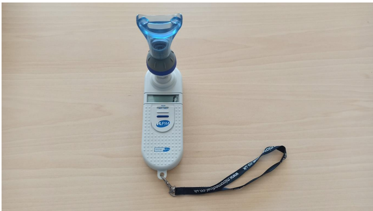
Εικόνα 3.1 Μετρητής αναπνευστικών πιέσεων (Micro-RPM). (Micro Medical Limited, Rochester, Kent, England).
