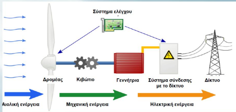
Σχήμα 2.5: Ο αναλυτικός τρόπος λειτουργίας των ανεμογεννητριών.[15]
