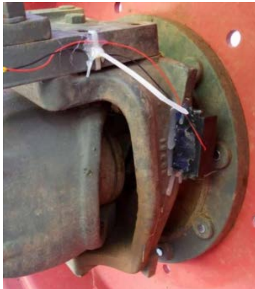
Εικόνα 2-7 Εφαρμογή Reed Switch μαζί με μαγνήτες στον τροχό του γεωργικού ελκυστήρα [4]
