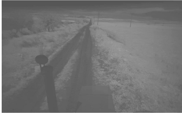
Εικόνα 3-5 Grayscale εικόνα με το red κανάλι της Agrocarn NIR κάμερας
