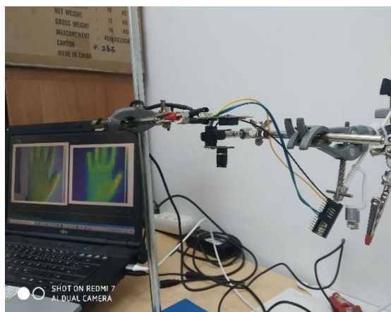
Εικόνα 2. Σύστημα καταγραφής και προβολής της θερμομέτρησης
