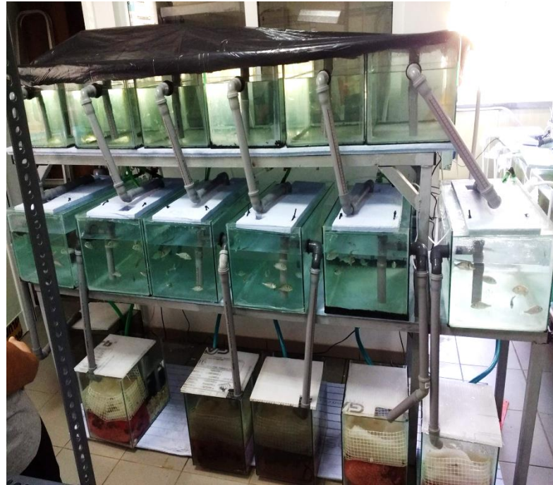
Εικόνα 5. Διάταξη αυτόνομων συστημάτων ενυδρειοπονίας που χρησιμοποιήθηκαν στην πειραματική διαδικασία. Διακρίνονται στην πρώτη σειρά τα grow bed, στη δεύτερη σειρά τα ενυδρεία εκτροφής των ψαριών και στο κάτω μέρος το φίλτρο τύπου sump (Πηγή: Μητσόπουλος και Μπαμπουκλής 2019).
