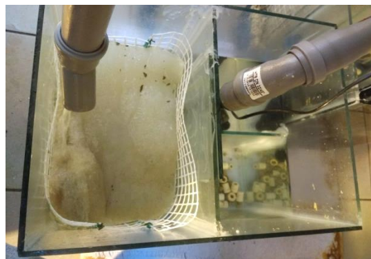
Εικόνα 6. Φίλτρο τύπου sump που χρησιμοποιήθηκε στο σύστημα ενυδρειοπονίας. (Πηγή: Μητσόπουλος και Μπαμπουκλής 2019)
