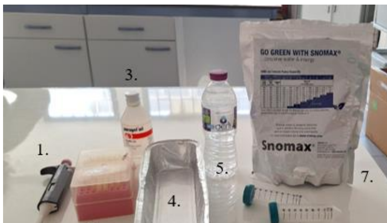
Εικόνα 40. Υλικά και όργανα που χρησιμοποιήθηκαν: 1.Πιπέτα ακριβείας 20 \mu L, 2. Tips πιπέτας, 3.Υγρή παραφίνη, 4. Δοχείο αλουμινίου, 5. Εμφιαλωμένο νερό, 6. Falcon, 7.Snomax
