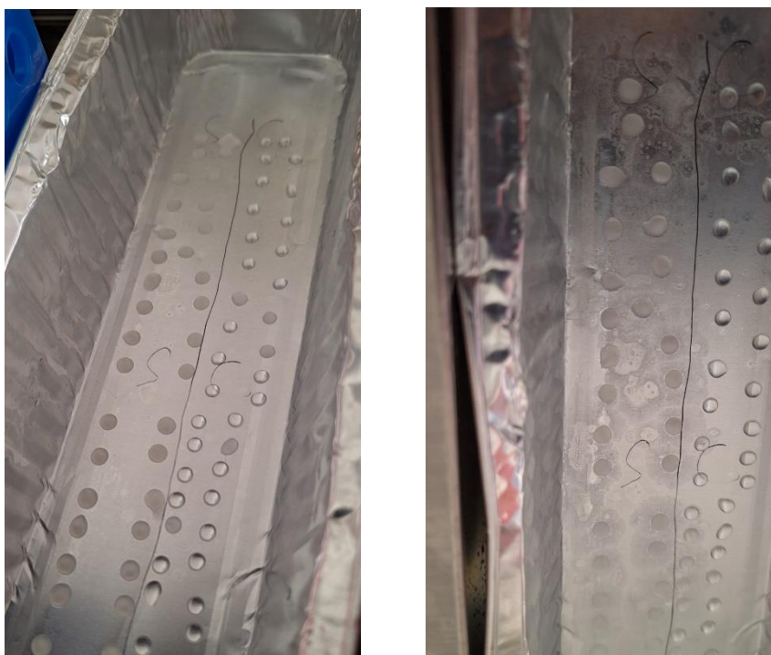
Εικόνα 43. Εικόνες από τη διεξαγωγή του πειράματος στους -5^{\circ}\text{C} αριστερά και στους -8^{\circ}\text{C} δεξιά, σε χρόνο 30 λεπτά και σε 2 λεπτά αντίστοιχα. Στο αριστερό μέρος κάθε εικόνας φαίνονται οι σταγόνες από το δείγμα που εμπεριέχει την πρωτεΐνη Snomax, ενώ δεξιά σταγόνες από το δείγμα αναφοράς
