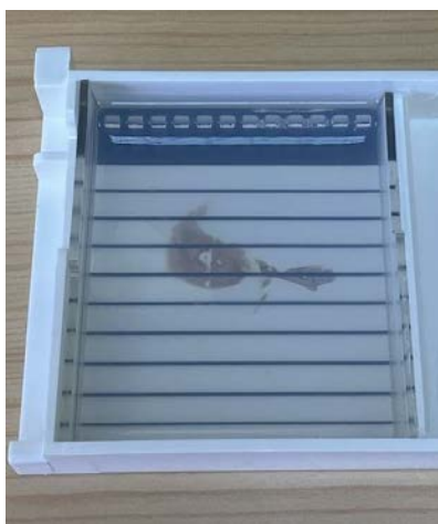
Εικόνα 21. Πηκτή αγαρόζης στο καλούπι. Στο επάνω μέρος του διακρίνονται τα βοηθία στα οποία τοποθετούνται τα δείγματα.
