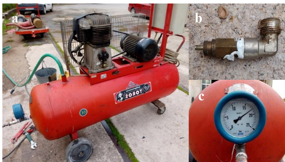
Εικόνα 57: Υδροστατική δοκιμή σε δοχείο συμπρέσορα (α), ασφαλιστική βαλβίδα (b), μανόμετρο (c)
