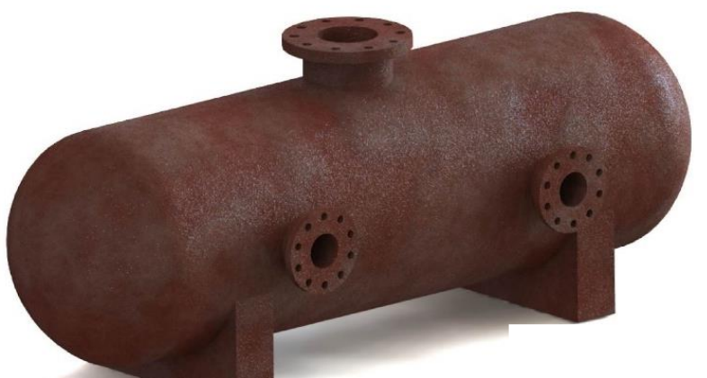
Εικόνα 19: Ομοιόμορφη διάβρωση σε αεροφυλάκιο [55]
