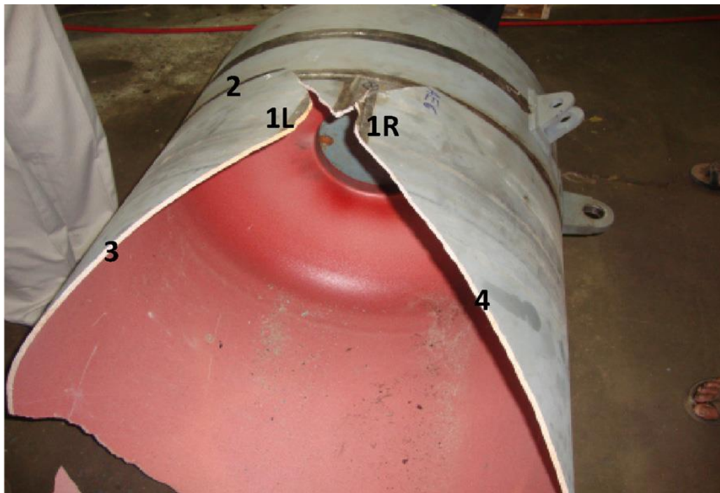
Εικόνα 38: Δειγματοληπτικές θέσεις λήψης δοκιμίων 1L, 1R, 2, 3, 4 [24]
