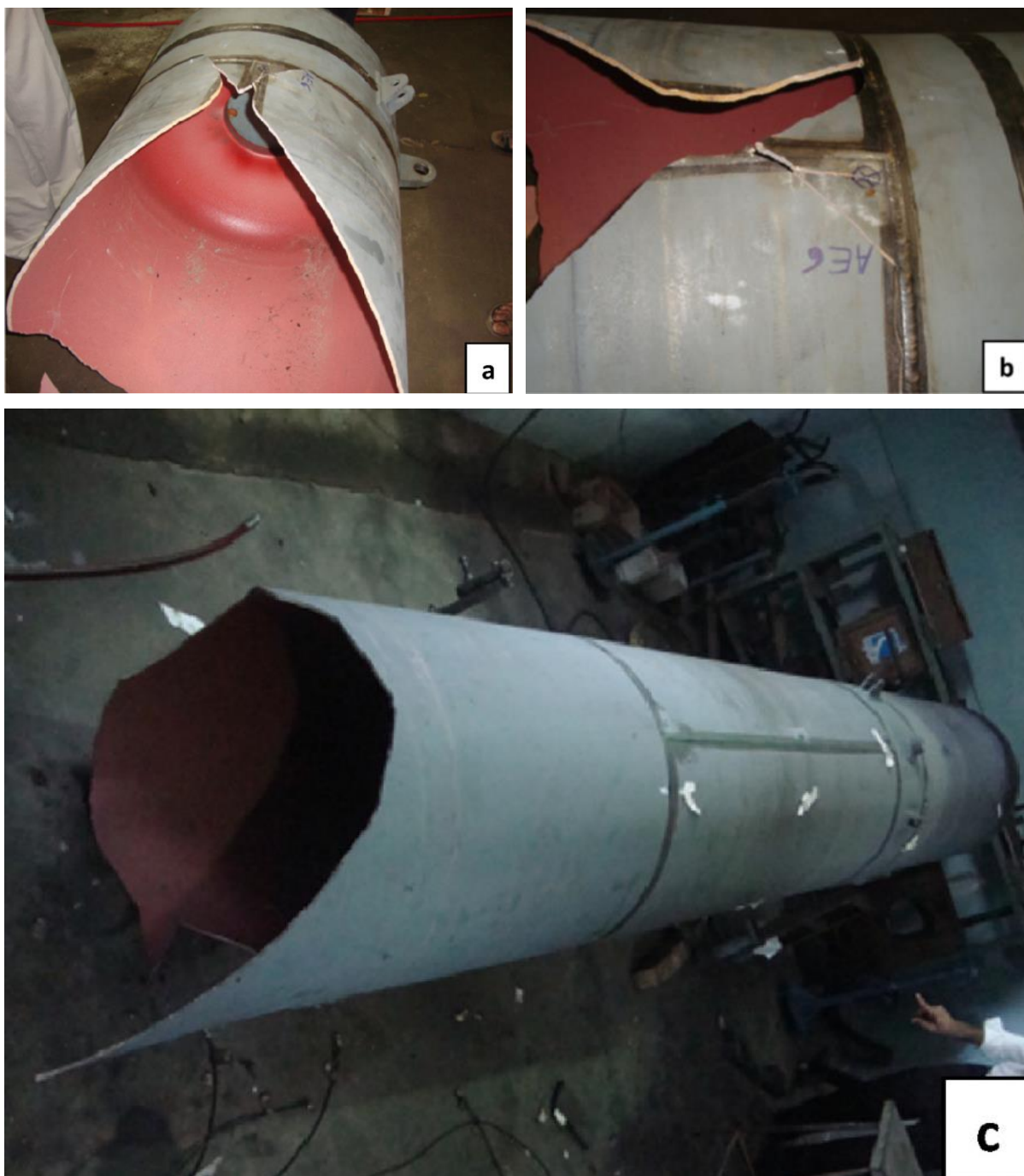
Εικόνα 35: (a, b) Κύριο σημείο αστοχίας της δεξαμενής SITVC [24], (c) το αποτυχημένο κέλυφος [24]
