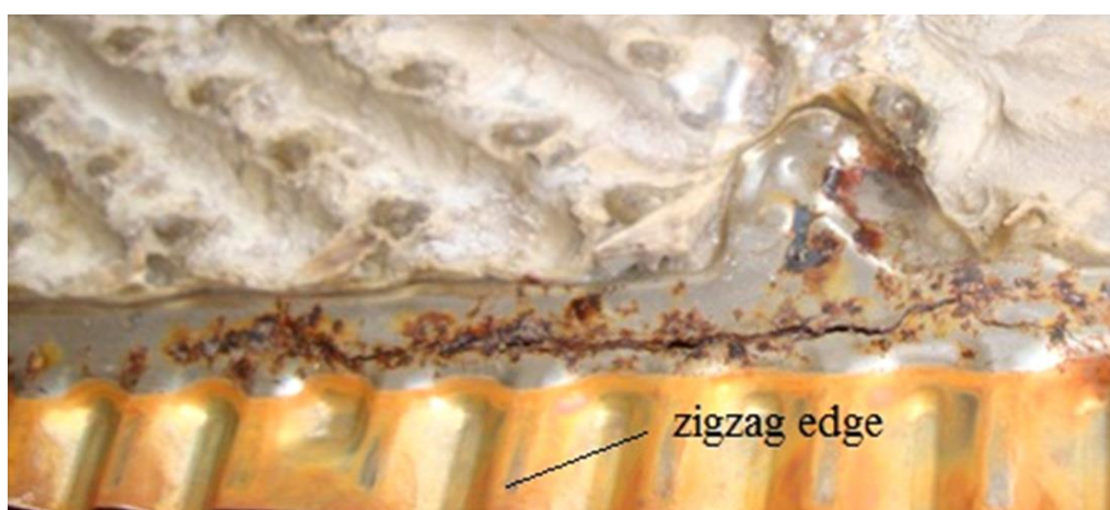
Εικόνα 52: Κοιλότητες και σχισμές διάβρωσης [26]
