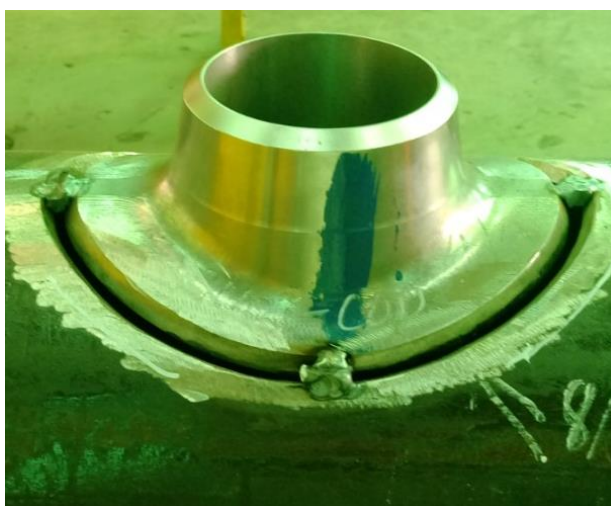
Εικόνα 31: Εξάρτημα τύπου weldolet - προσαρμογή [36]
