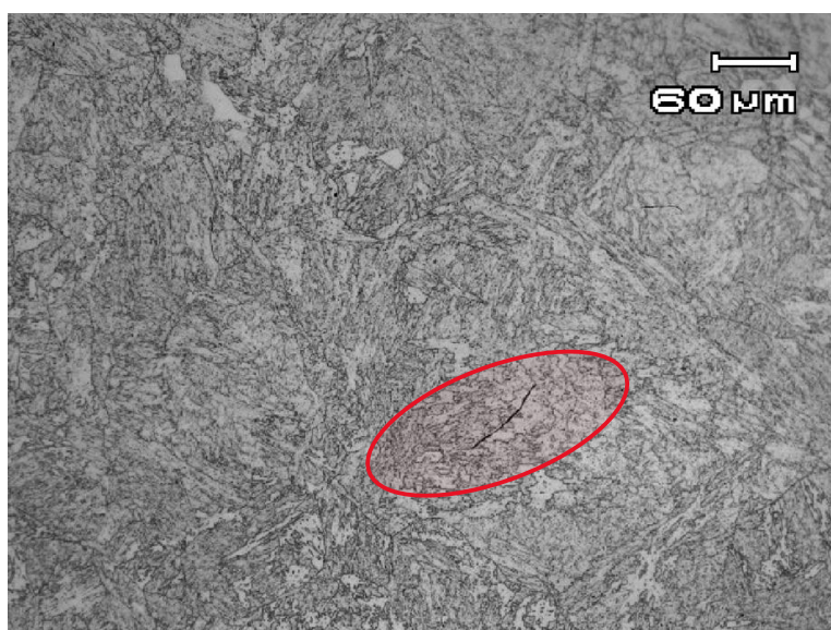
Εικόνα 42: Υπό σκλήρυνση μαρτενσίτης [24]
