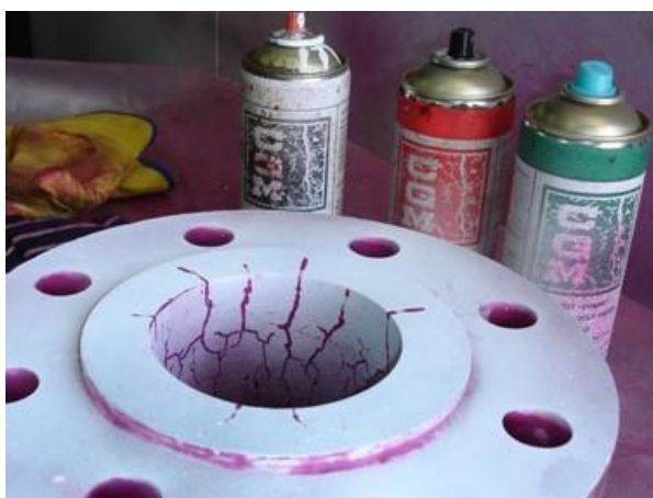
Εικόνα 60: Εφαρμογή διεισδυτικών υγρών σε μεταλλικό εξάρτημα [40]
