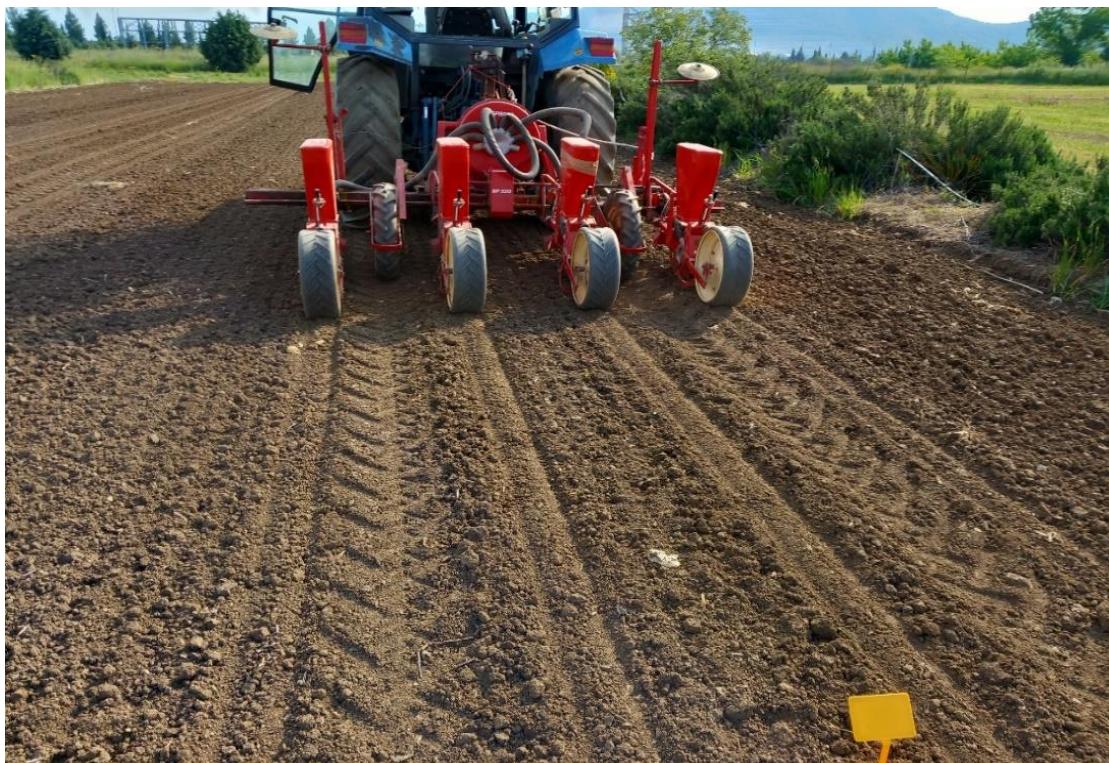
Εικόνα 2.2. Σπορά ρετινολαδιάς με πνευματική σπαρτική μηχανή 4 σειρών.
