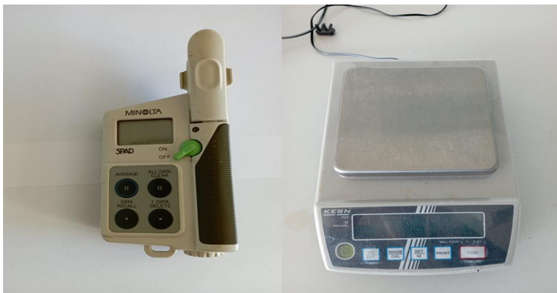
Εικόνα 2.3. Μετρητής χλωροφύλλης SPAD-502 (αριστερά) και ζυγός ακριβείας (δεξιά).
