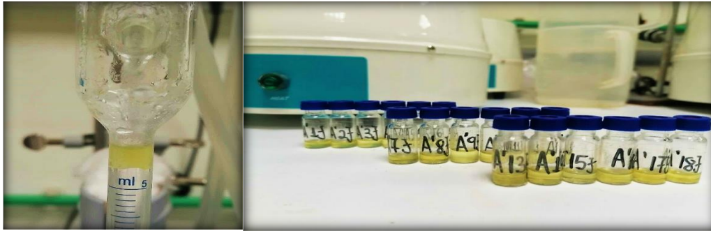
Εικόνα 2.25. (αριστερά) Αιθέριο έλαιο L.angustifolia στο σωλήνα της συσκευής απόσταξης “Clevenger”, 26/10/2023 & Εικόνα 2.26. (δεξιά) Αιθέριο έλαιο L. angustifolia , 27/10/2023
